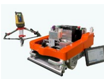
墨出しロボット(3機種)
